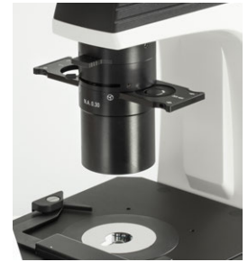
N.A. 0,3 Abbe Condenser with phase contrast slide
