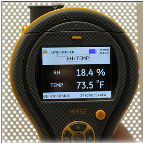
Figur 4: MMS2 som hygrometer
